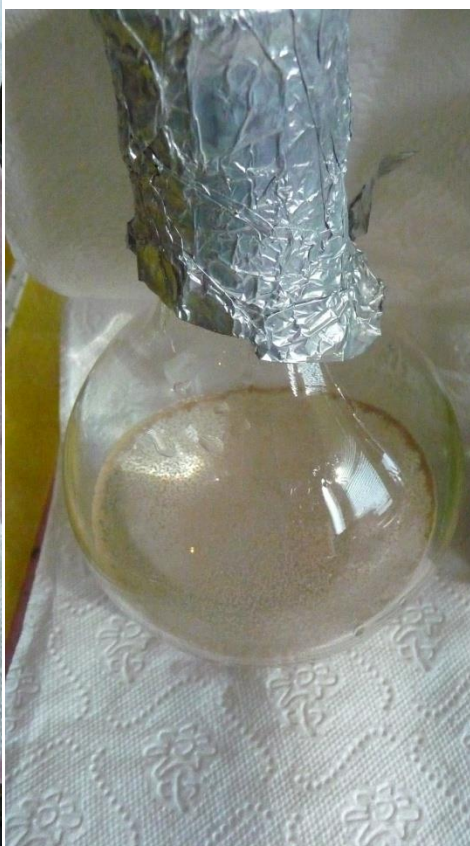
Obr.8 Mikrogranulát – nejaký čas sa musí rozpúšťať, aby sa uvoľnili mikroorganizmy
