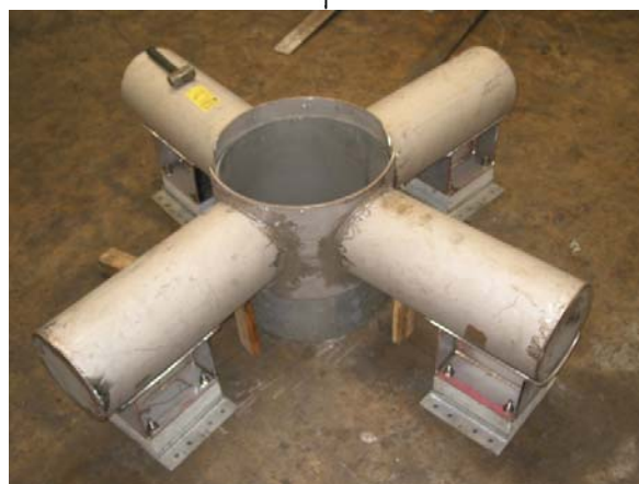
Obr. 3-2. Pevný bod - objímka s čapom. Potrubie je
