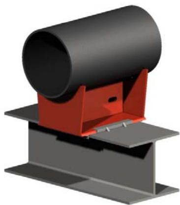
Obr. 3-1. Pevný bod - sedlová podpera. Potrubie je pevne (
