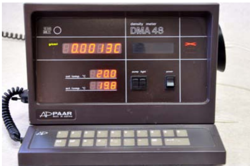
Obr. 4.1 Digitálny hustomer DMA 48
