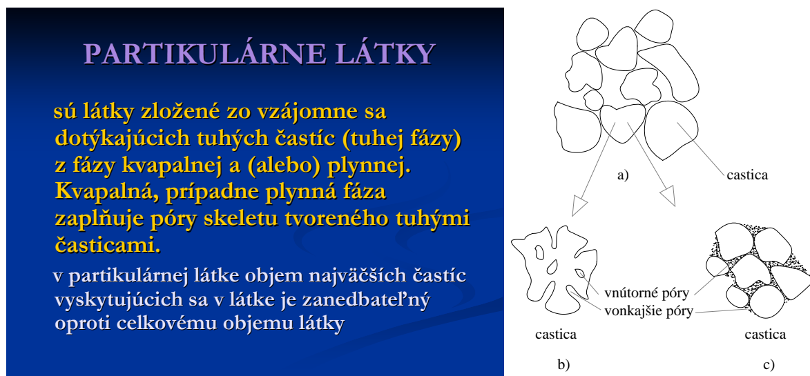
Obr.1 Partikulárna látka. a) partikulárna látka tvorená vzájomne sa dotýkajúcimi časticami, b) primárna častica s vnútornými a vonkajšími pórmi c) agregát z primárnych častíc spojených pevnými väzbami do jedného celku - častice.
