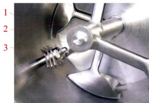
Obr. 46 Diskontinuálny miešač. a) pohľad na otvorený diskontinuálny miešač, 1. komora, 2. násypný otvor, 3. výsypné otvory, 4. kontrolný otvor, 5. hriadel' s miešacími elementami pluhového tvaru, 6. veko, 7. rameno, 8. pätky, 9. rám, 10. pohon, b) pohľad ho komory miešača, 1. komora, 2. miešacie elementy pluhového tvaru, 3. deaglomeračná vrtuľka.
