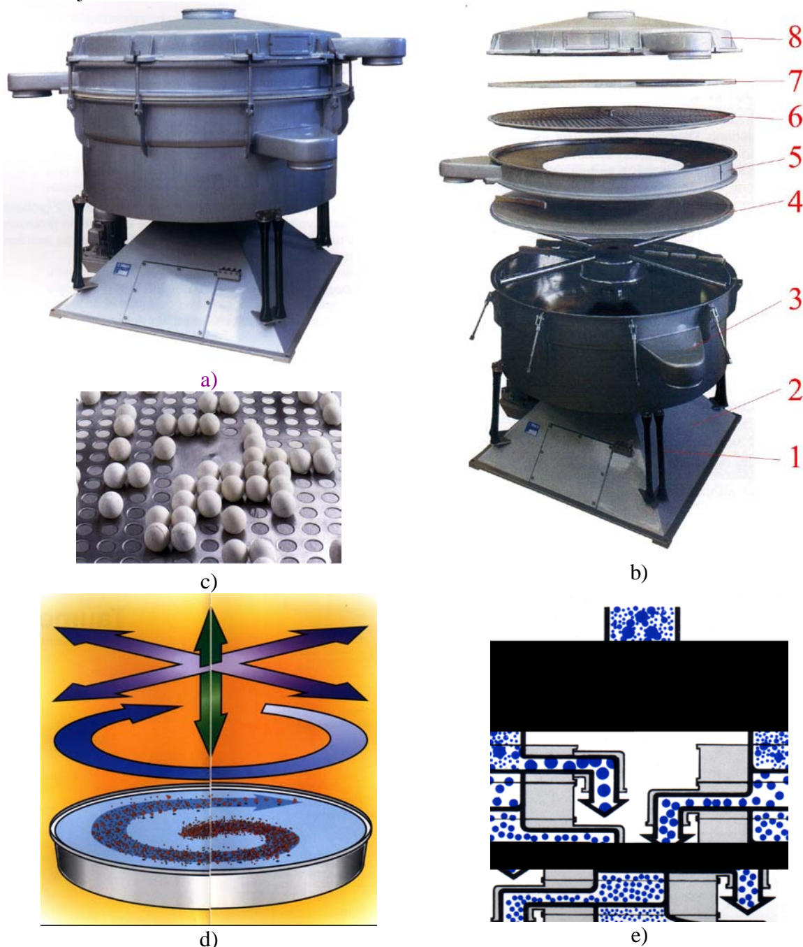
Obr. 52 Kruhový vibračný triedič. a) pohľad na triedič, b) zostava triediča, 1. pružiny, 2. podstavec s pohonným mechanizmom, 3. nádoba s výsypaným otvorom pre najjemnejší podiel, 4. sito pre najjemnejší podiel, 5. dilatačný prstenec s výsypaným hrdlom, 6. rošt, 7. sito pre najhrubší podiel, 8. veko s výsypaným hrdlom pre najhrubší podiel, c) rošt s guľkami, d) schematické znázornenie pohybov sita, e) schematické znázornenie triedenia.
