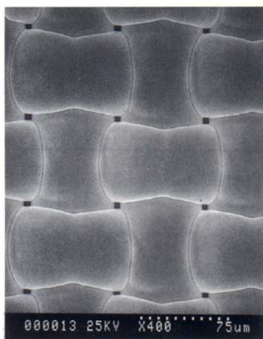
Metallfilter mit Porengrößen von max. 5.0 \mu\text{m}
