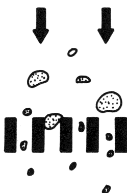
a) sitový efekt, povrchová filtrácia, cedenie na povrchu
