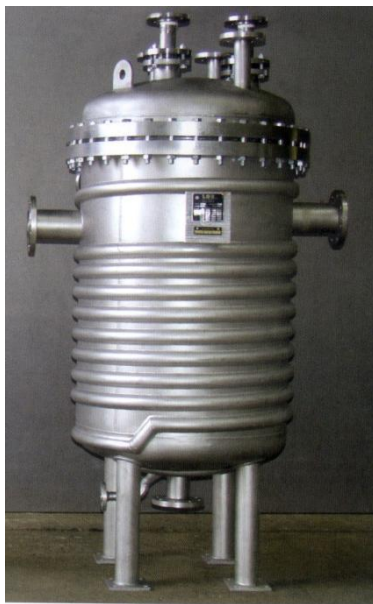
Obr. 2.5. Nádoba s navinutým ohrevným hadom [9]
