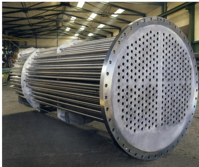
Obr. 2.20. Pohľad na rúrkovnicu a rúrky výmenníka tepla s U-rúrkami [9]
