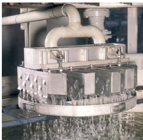
Obr. 10.7. Distribútor kvapaliny v kolónovom aparáte [9]
