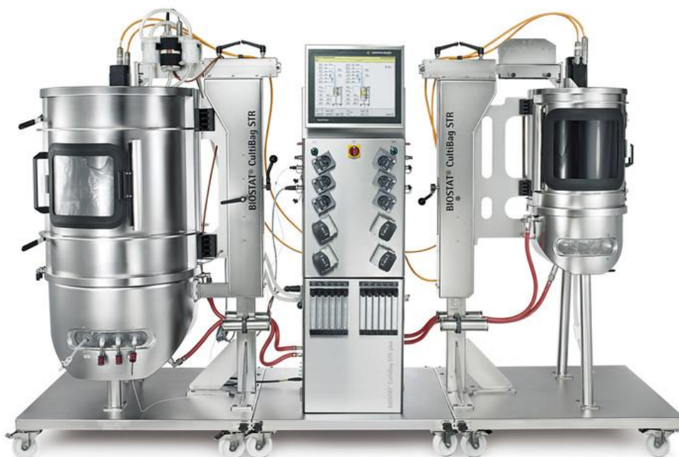
Obr. 13.23. Skutočné vyhotovenie stanice s inokulačným a kultivačným bioreaktorom [48]
